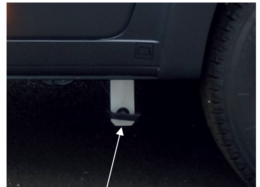
Handgriff zur Entleerung des Abwassertanks
