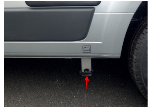
Handgriff zur Entleerung des Abwassertanks
