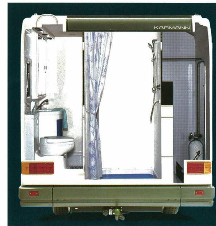
Der Sanitärbereich des Missouri 635 SD verfügt über eine zusätzliche separate Dusche im Heck. Ein zweiter Frischwassertank sorgt dafür, daß dieser Luxus auch voll ausgenutzt werden kann.
