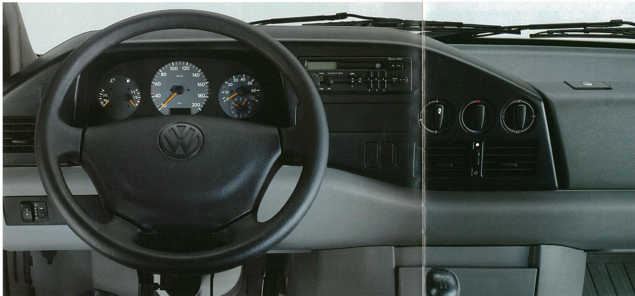
Das Cockpit. Serienmäßige 5-Gang-Schaltung, Servolenkung, ergonomisch aufgebaute Instrumententafel mit Kilometer- und Tageskilometeranzeige, Drehzahlmesser, Bremskontrollleuchte und einer Kontrolleuchte für die Trittstufe des Aufbaus.
