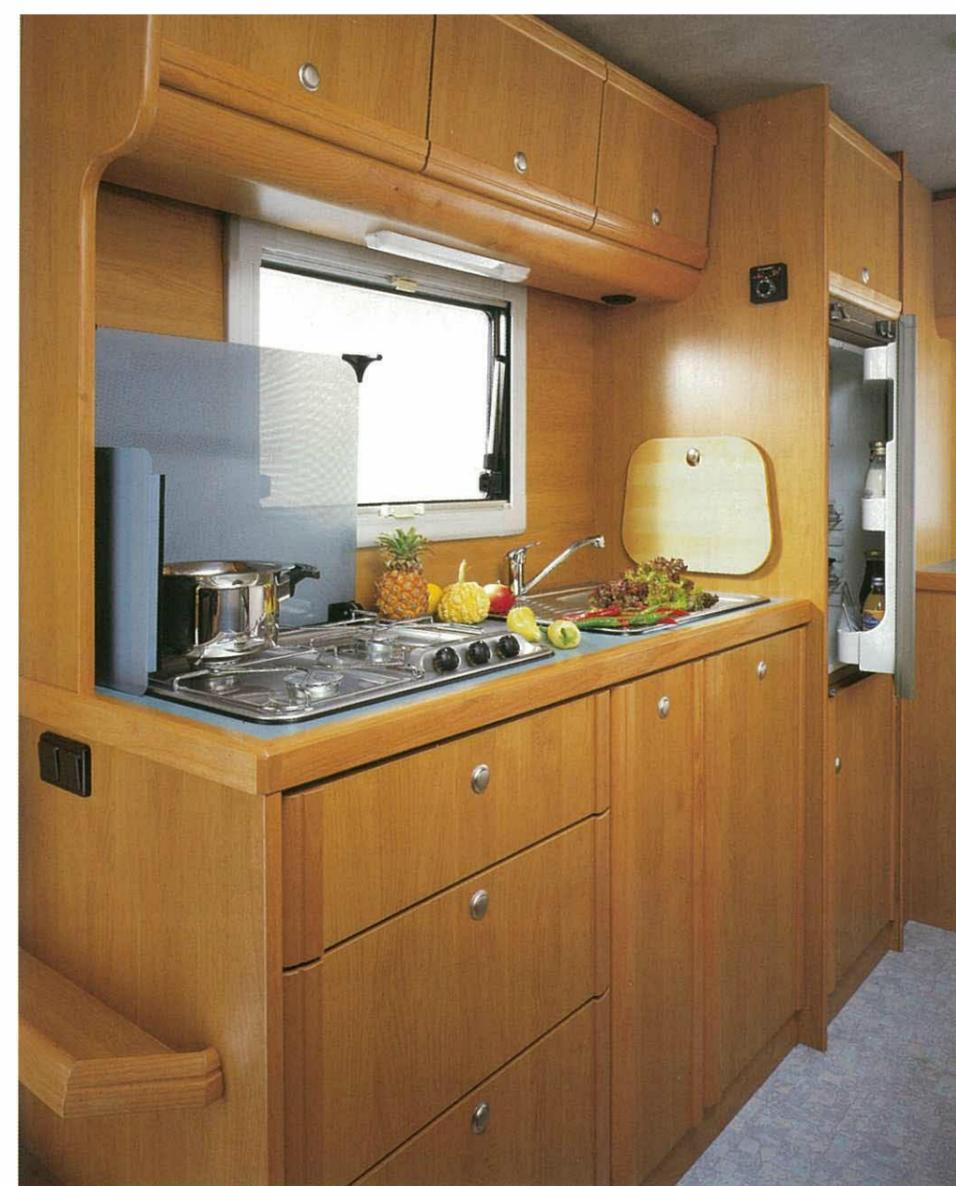
Die Küche der S-Modelle glänzt mit einem Gasherd mit drei Kochstellen. Neben der Spüle befindet sich eine zusätzliche Abtropffläche. Der Unterschrank auf robusten Rollslagern läßt sich bequem von beiden Seiten beschicken. Der Kühlschrank mit 88 Litern Rauminhalt incl. 6 Liter Gefrierfach ist in Arbeitshöhe untergebracht und macht das Bücken überflüssig.
