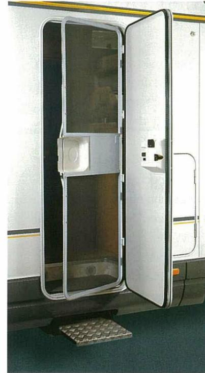
Ausgestattet mit einem soliden Drehfallenschloß: die extrabreite Aufbautür der Missouri-Modelle. Das integrierte Fliegengitter hilft, auch bei geöffneter Tür die kleinen ungebeten Gäste draußen zu halten.
