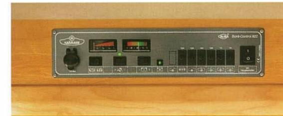
Bei allen Missouri-Modellen wird die Bordelektrik über ein zentrales Panel, leicht zugänglich über der Auftür, gesteuert. Es informiert über die wichtigsten Kontrollfunktionen und sichert die Stromkreise für den Aufbau über Sicherungsautomaten ab.
