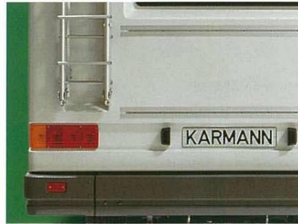
Trägerschienen am Heck ermöglichen die unkomplizierte Befestigung von Radträgern. Auf dem Dach eingelassene Trägerschienen bieten Aufnahmepunkte für Surfbretthalter oder Dachbox.
