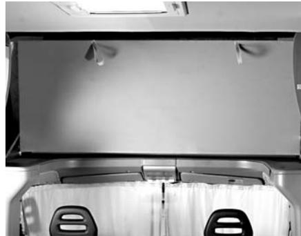
Pour garantir un accès aisé à la cabine du conducteur, le sol du lit capucine peut être relevé à 90°.
