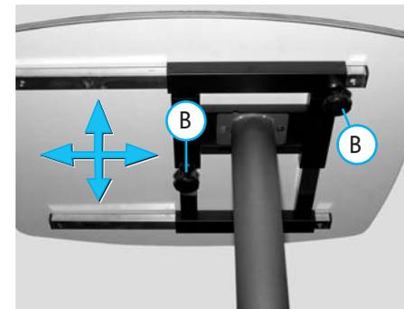
Le plateau dans la banquette en L peut être déplacé à la fois longitudinalement et transversalement au sens de la marche. Pour le réglage, desserrez les vis moletées B qui se trouvent sous le plateau et poussez celui-ci dans la position souhaitée.
