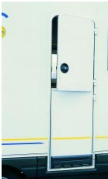
Der Davis 630 M verfügt über eine zweiteilige Aufbautür und ist mit einem soliden Schloß ausgestattet.
