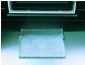
Sicherheit und Komfort bereits beim Einstieg: Die Trittstufe der Davis-Modelle. Eine Kontrolllampe im Fahrerhaus warnt bei Fahrt mit ausgefahrener Trittstufe.
