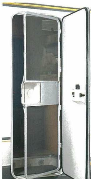
*Die extrabreite Aufbautür des Missouri 600 S ist mit einem soliden Drehfallenschloß gesichert. Das integrierte Fliegengitter hält die kleinen Störenfriede fern und läßt sich separat schließen.*
