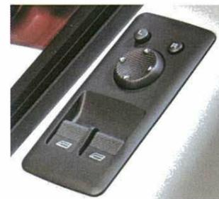
Bedienung für elektrische Fensterheber und elektrische Außenspiegelausstellung
