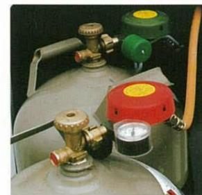
Die Duomatic L schaltet automatisch auf die Reserve-Gasflasche. Eine LED-Anzeige im Wageninneren zeigt an, aus welcher Flasche Gas entnommen wird.
