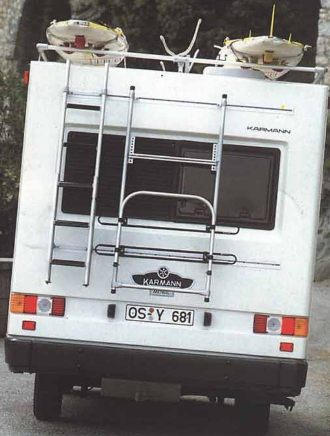
**Die Aluminium-Dachträger-Konstruktion**, speziell entwickelt von Karmann, bietet durch Zusatzhalter Unterbringungsmöglichkeiten für Surfboards und Kajaks sowie am Heck für Skier und Fahrräder.
