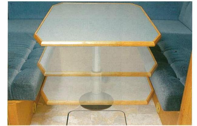
Nach dem Lösen der Arretierschraube läßt sich die Tischsäule im Boden versenken. Die Rückenpolster der Sitzgruppe komplettieren die Matratze. Eine Gasdruckfeder bringt die Tischplatte am nächsten Morgen in die Ausgangsposition zurück.
