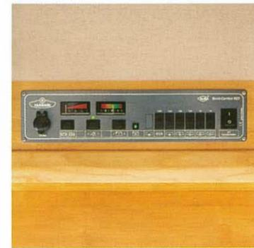
Die Bordelektrik wird über ein zentrales Panel, leicht zugänglich über der Auftür, gesteuert. Es informiert über die wichtigsten Kontrollfunktionen und sichert die Stromkreise für den Aufbau über Sicherungsautomaten ab.
