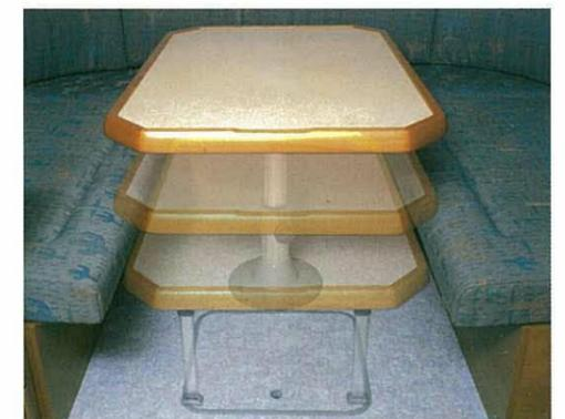
Nach dem Lösen der Arretierschraube lässt sich die Tischsäule im Boden versenken. Die Rückenpolster der Sitzgruppe komplettieren die Matratze. Eine Gasdruckfeder bringt die Tischplatte am nächsten Morgen in die Ausgangsposition zurück.
