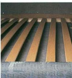
Einlamierte Träger-schienen am Heck ermöglichen die unkomplizierte Befestigung von Radträgern. Alle Colorado-Modelle verfügen serienmäßig über eine dritte Bremsleuchte.
