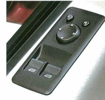
Bedienung für elektrische Fensterheber und elektrische Außenspiegelausstellung
