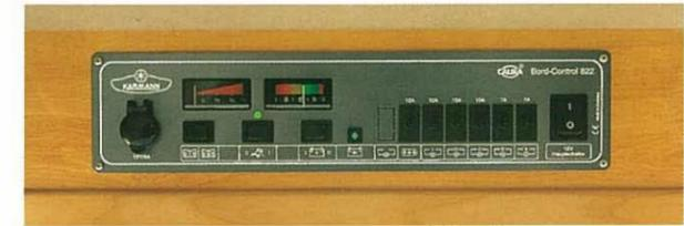
Die Bordelektrik wird über ein zentrales Panel, leicht zugänglich über der Aufbautür, gesteuert. Es informiert über die wichtigsten Kontrollfunktionen und sichert die Stromkreise für den Aufbau über Sicherungsautomaten ab.
