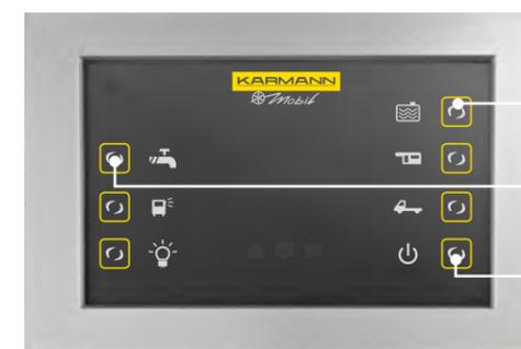
Kontrolleuchte Füllstand des Frischwassertanks
