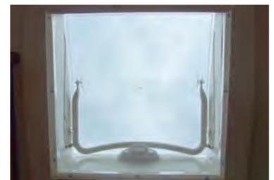
Um das Oberlicht zu öffnen, drücken Sie auf den Entriegelungsknopf, um den Bügel zu entriegeln, und ziehen Sie den Bügel nach unten. Ziehen Sie ihn dann zu sich hin, um ihn an einem der drei Öffnungspunkte einzurasten.
