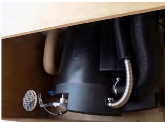
Ihr Fahrzeug ist mit dem Gerät TRUMA D4 oder TRUMA Combi 4 oder 6, einer Heizung mit integriertem Boiler, ausgestattet, die mit Dieselkraftstoff betrieben wird (es sei denn, das Fahrzeug ist mit der Gasvariante ausgestattet).
