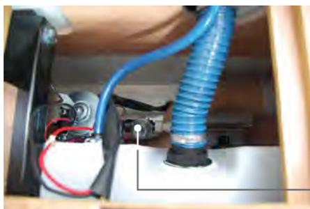
Die Pumpe befindet sich unter der vorderen Bank, neben dem Frischwassertank.
