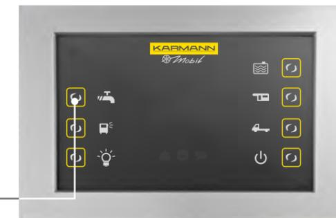
Schaltfläche zum Einschalten der Stromversorgung der Pumpe
