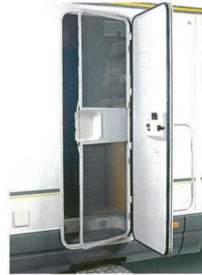
Ausgestattet mit einem soliden Drehfallschloß: die extrabreite Auftür der Missouri-Modelle. Das integrierte Fliegengitter hilft, auch bei geöffneter Tür, die kleinen ungebeten Gäste draußen zu halten.
