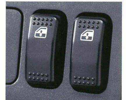
Bequem von Fahrer und Beifahrer zu erreichen: die in der Schalttafel integrierten Bedienelemente für die elektrischen Fensterheber
