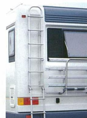
Das Dach ist über eine zweiteilige, klappbare Leiter erreichbar.
