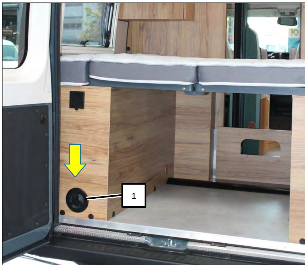
Accès au levier de vidange du réservoir d'eau propre (exemple)
