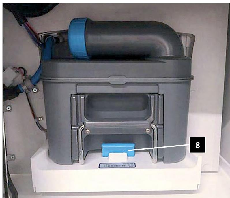
Kassette, eingerastet (Abb. beispielhaft)
