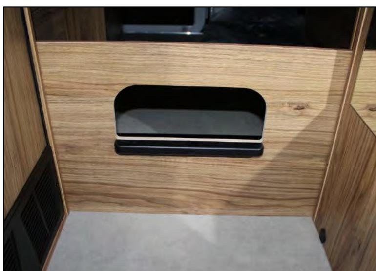
Abtrennung mit Trittstufe (Abb. beispielhaft)
