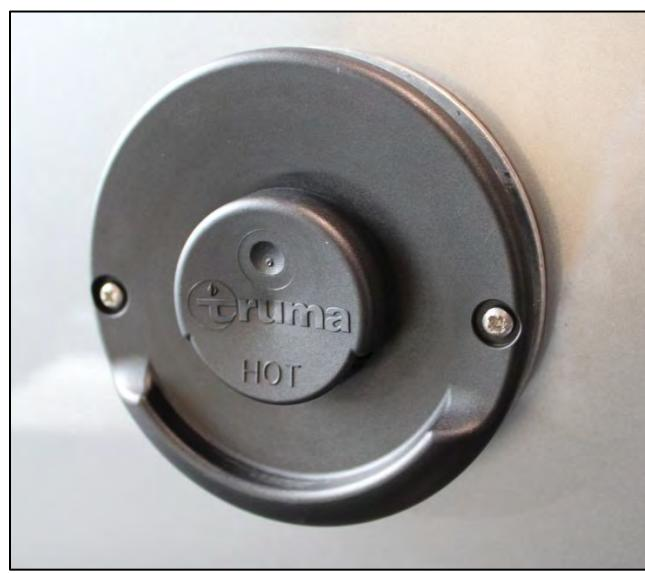
Évacuation/arrivée d'air à l'extérieur du véhicule (exemple)
