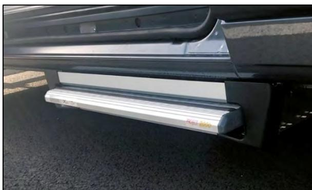
Ihr Fahrzeug ist mit einer elektrischen Trittstufe für leichteren Zugang zum Wohnraum ausgestattet.
