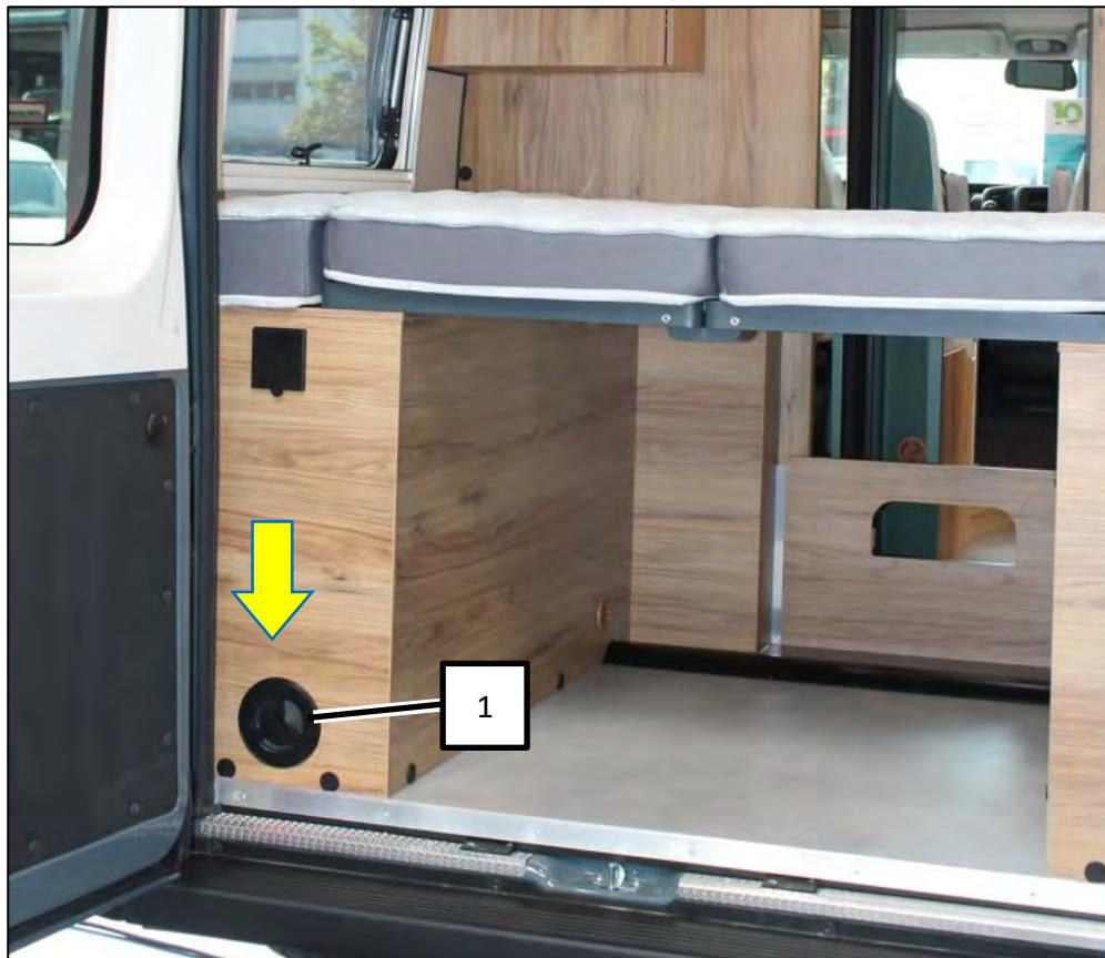
Zugang zum Ablass-Hebel des Frischwassertanks (Abb. beispielhaft)
