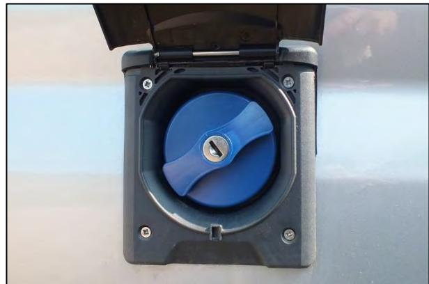
Bouchon de remplissage d'eau propre (exemple)
