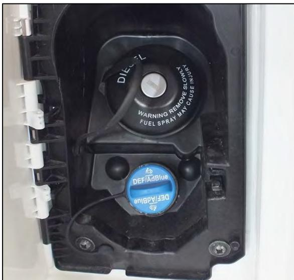
Bouchon de remplissage pour AdBlue à côté de la porte conducteur (exemple)
