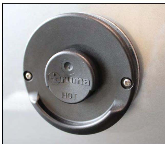
Abluft/Zuluft-Element an der Fahrzeugaußenseite (Abb. beispielhaft)
