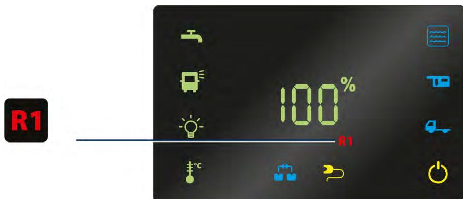
Signal d'avertissement du réservoir d'eaux usées (exemple)
