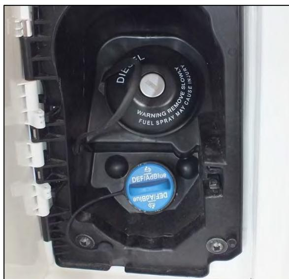
AdBlue Einfüllöffnung neben der Fahrertür (Abb. beispielhaft)
