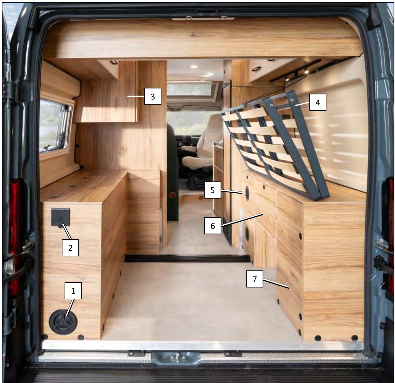
Transportstellung beim Dexter 580: der Lattenrost ist hochgeklappt (Abb. beispielhaft)
