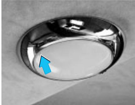
Die Deckenleuchte „Ufo“ ist mit einer 12 Volt/21 Watt-Glühlampe ausgestattet.
