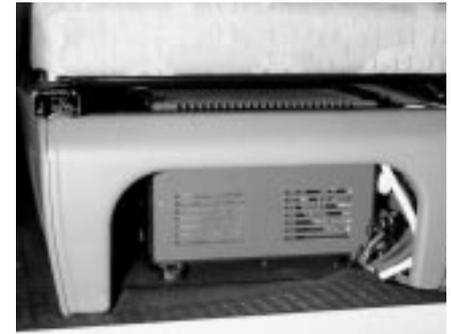
Das EVS-Ladegerät (Gel-Batterie tauglich) befindet sich, je nach Grundriss, unter oder hinter dem Beifahrersitz.
