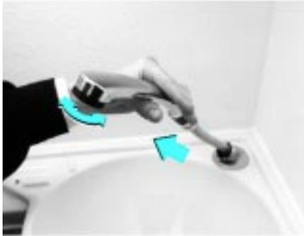
Das Waschbecken Ihres Karmann-Reisemobils ist mit einem Einhebelmischer zur Regulierung der Kalt- und Warmwasserentnahme sowie einem Duschkopf mit Schlauch ausgestattet. Zum Duschen ziehen Sie den Duschkopf aus seiner Halterung im Waschbecken und befestigen ihn am Duschkopfhalter an der Wand. Der Wasserstrahl lässt sich durch Drehen am Duschkopf verändern.
