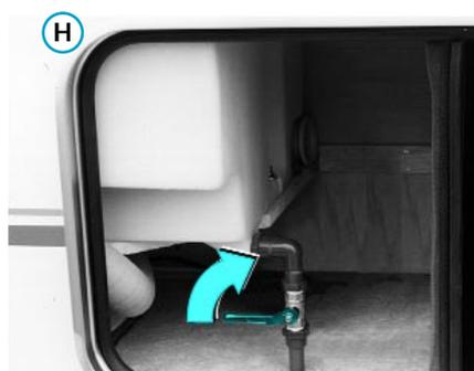
Sitzgruppe. Der Filter sollte mindestens einmal pro Jahr unter fließendem Wasser gereinigt werden. Lassen Sie vor der Filterreinigung das Frischwasser aus dem System ab.
