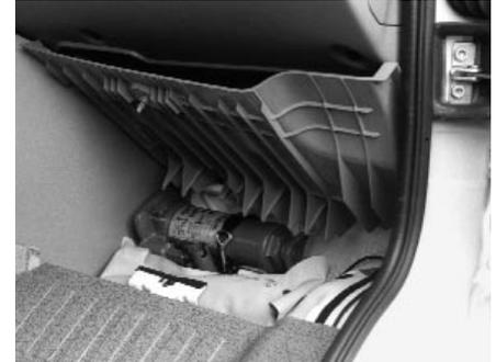
Das Bordwerkzeug befindet sich im Fußraum an der Beifahrerseite.
