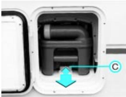
Der Fäkalientank ist von außen auf der Fahrerseite zugänglich.
