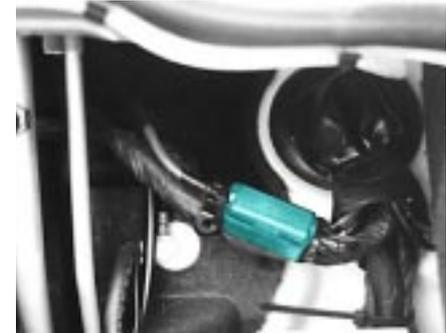
Die Starterbatterie im Motorraum wird durch eine Schmelzsicherung vor einer Überlastung durch zu starke Verbraucher (z. B. Kühlschrank, 12 V-Betrieb) geschützt. Sollte die Aufbaubatterie während der Fahrt nicht geladen werden, kontrollieren Sie bitte auch diese Sicherung und tauschen Sie sie gegebenenfalls aus.
