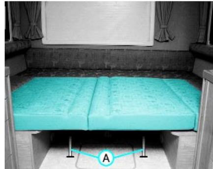
Hecksitzbank füllen Sie die verbleibenden freien Flächen aus. Zum Umbau in die Sitzposition verfahren Sie in der umgekehrten Reihenfolge.
