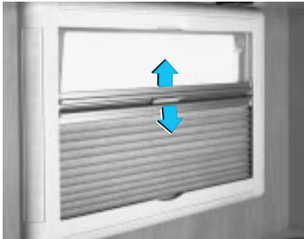
Alle Ausstellfenster sind mit einem Verdunklungs- und Insektenschutzrollo ausgestattet. Die Abbildung zeigt die beiden Rollos in jeweils halb geöffneter Stellung. Beide Rollos können Sie zusammen oder getrennt nach oben und unten verschieben.
