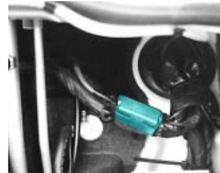
Die Starterbatterie im Motorraum wird durch eine Schmelzsicherung vor einer Überlastung durch zu starke Verbraucher (z. B. Kühlschrank, 12 V-Betrieb) geschützt. Sollte die Aufbauatterie während der Fahrt nicht geladen werden, kontrollieren Sie bitte auch diese Sicherung und tauschen Sie sie gegebenenfalls aus.
