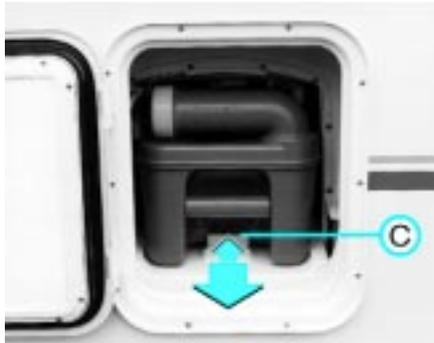
Der Fäkaliertank ist von außen auf der Fahrerseite zugänglich.
