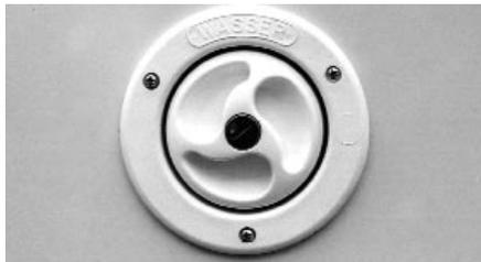
Die Wasserversorgung Ihres Karman-Reisemobils erfolgt über den eingebauten Frischwassertank. Eine elektrische Druckpumpe pumpt das Wasser zu den Verbrauchsstellen in Küche und Bad.
