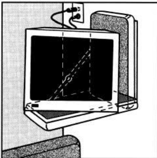
Das am Kleiderschrank befindliche Polster ist in ausgeklappter Position Halterung für einen Fernseher. Zum Anschluß sind oberhalb der Ablage drei Steckdosen (12V, 220V u. Antenne) vorgesehen.
