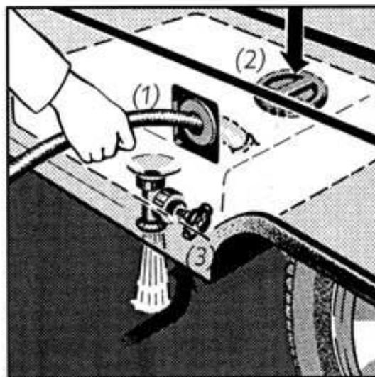
Der Frischwassereinfüllstutzen befindet sich in Fahrtrichtung rechts hinter der Hinterachse.
