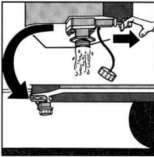
Der Abwassertank befindet sich in Fahrtrichtung links unter dem Fahrzeug. Eine Entleerung erfolgt über den Ablaßhahn. Die Entsorgung nehmen Sie bitte an den dafür vorgesehenen Entsorgungsstationen vor. Der Umwelt zuliebe.
