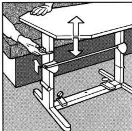
Zum Aufstellen und Zusammenklappen des Tisches ist der Entriegelungshebel nach oben zu ziehen. Mit der Feststellschraube und dem Halterungsblech wird der Tisch am Boden in Position gehalten.
