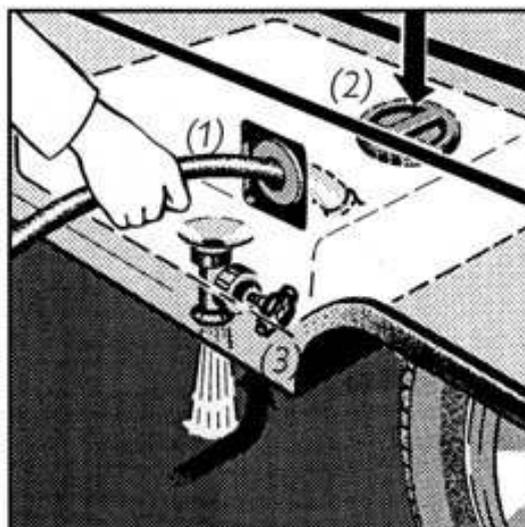
Der Frischwassereinfüllstutzen befindet sich bei dem Modell »L« in Fahrtrichtung seitlich links vor der Hinterachse (1). Bei dem Modell »H« in Fahrtrichtung rechts hinter der Hinterachse. Die Reinigung erfolgt von innen durch eine Öffnung unterhalb der Sitzbank (2). Bei längerer Abstellzeit ist der Frischwassertank über den Abflaßhahn (3) zu entleeren.
