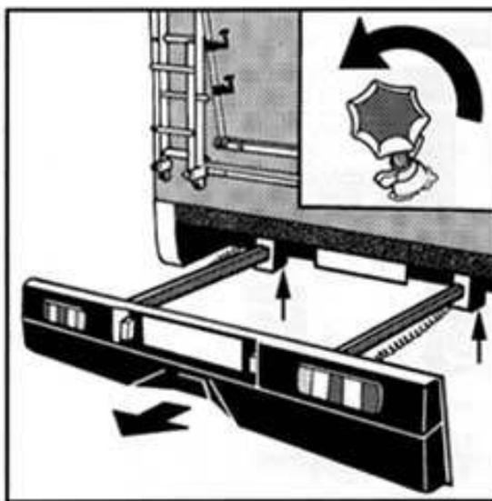
Die hintere Stoßstange ist beidseitig mit Rändelschrauben gegen Herausrutschen gesichert. Zum Ausziehen beide Schrauben lösen und Stoßstange vorsichtig bis auf beliebige Länge herausziehen. Eine bis vier Fahrradträgerschienen können auf die Trägerprofile montiert werden. (Zum Teil Sonderausstattung).
