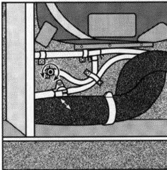
Bei Frostgefahr sind die Entleerungsventile zu öffnen.
