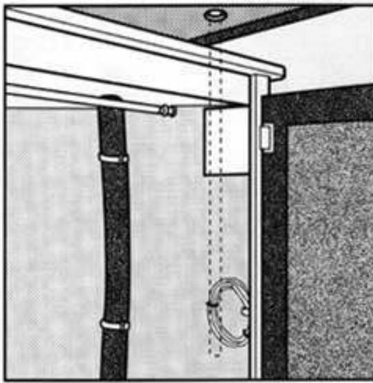
Im Kleiderschrank ist eine Antennenvorbereitung angebracht. Eine eventuell montierte Antenne kann von innen verdreht werden. Ebenfalls wird mit dieser Vorrichtung die Antenne gesenkt.
