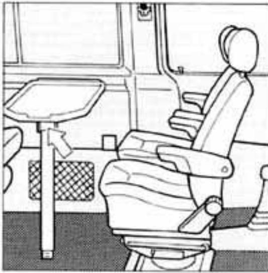
Dabei werden die vorderen Sitze mit einbezogen. Die Entriegelung für die Dreheinrichtung befindet sich bei beiden Sitzen jeweils rechts unten am Sitzfuß. Zum Entriegeln Hebel nach oben ziehen. Beide Sitze werden links herum gedreht, dabei müssen ggf. die Sitze etwas nach vorne geschoben werden bzw. die Türen geöffnet werden. Der Tisch wird zum Bettenbau nicht benötigt. Die Entriegelung befindet sich am oberen Ende des Tischbeines. Diese muß gedrückt und das Tischbein seitlich abgeklappt werden.
