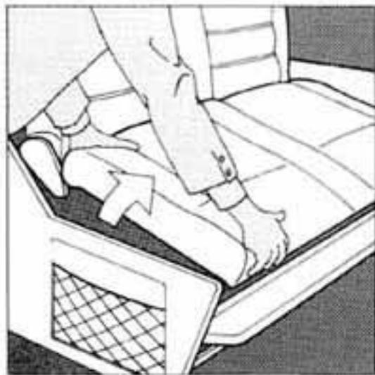
Die Sitzfläche der Doppelsitzbank wird in dem hinteren Bereich als erstes leicht angehoben und danach komplett herausgeklappt
