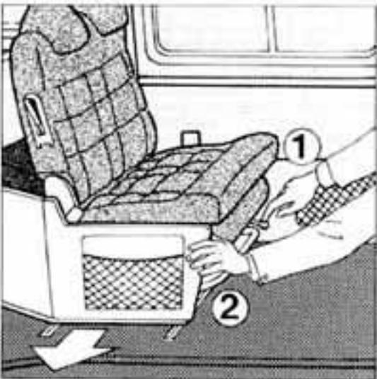
Damit die Sitzbank verschoben werden kann, muß die Entriegelung (1), in Fahrtrichtung links, nach unten gedrückt werden. Man verschiebt die Sitzbank (2) so weit, bis sie wieder einrastet.
