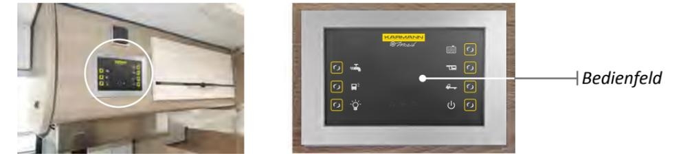
Mit dem Bedienfeld können Sie die verschiedenen elektrischen Geräte Ihres Fahrzeugs ansteuern und mehrere Parameter für die optimale Nutzung des Wohnraums kontrollieren.
