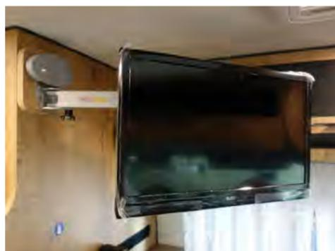
Das TV-Gerät kann unabhängig mit 12 V oder 230 V betrieben werden.
