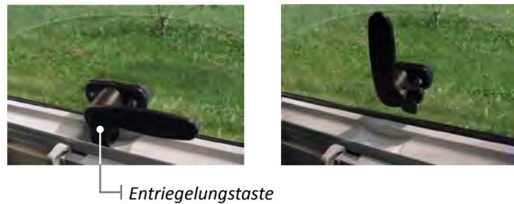
Um das Fenster zu öffnen, entriegeln Sie den Hebel durch Druck auf den Entriegelungsknopf und drehen Sie den Hebel nach links in die senkrechte Stellung.
