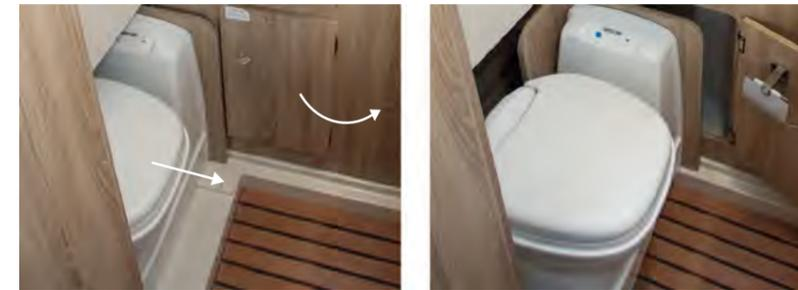
Schwenken Sie vor Benutzung die WC-Schüssel in eine komfortable Position. Es wird empfohlen, mit dem Spülknopf Wasser in die WC-Schüssel fließen zu lassen. Das Wasser hört auf zu fließen, sobald der Spülknopf losgelassen wird.
