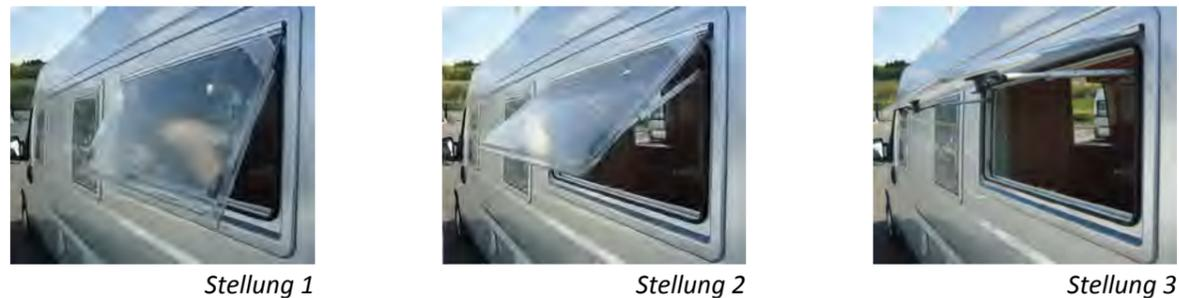
Schließen Sie das Fenster wieder, indem Sie es bis zum Anschlag öffnen und dann vorsichtig herunterlassen.
