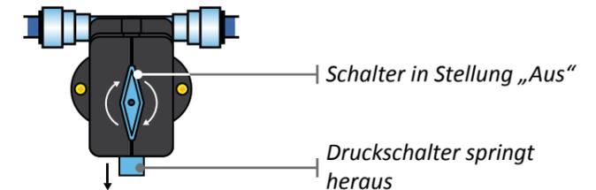
Das Wasser aus dem Boiler wird nun über das Ablassventil nach außen abgelassen. Stellen Sie einen Behälter unter den Auslass, um sicherzustellen, dass der Boiler vollständig geleert wurde (ca. 10 Liter).
