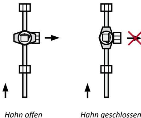
Um die Anlage in Betrieb zu nehmen, schließen Sie das Hauptabsperrventil an der oberen Flasche an. Nachdem das Hauptabsperrventil angeschlossen wurde, bewegen Sie den Hahn um eine Vierteldrehung, um die Gaszufuhr zu öffnen.
