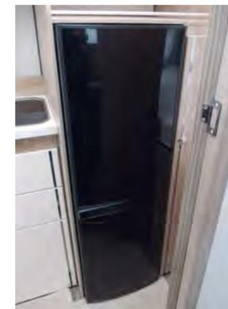
Ihr Fahrzeug ist mit einem Kühlschrank der Marke **Dometic** mit **AES** (automatisches Energiewahl-System) ausgestattet. Dieser Kühlschrank kann am Netz (230 V Wechselspannung), mit 12 V Gleichspannung oder mit Propangas betrieben werden. Über die Taste MODE kann zwischen diesen Energiearten umgeschaltet werden.
