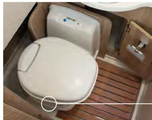
Die WC-Schüssel ist schwenkbar und mit einem Klappsitz und Deckel ausgestattet. Mit einem Riegel unter dem Sitz lässt sich ein Schieber öffnen, um die WC-Schüssel zu entleeren.
