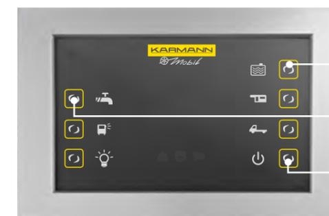
Kontrollleuchte Füllstand des Frischwassertanks
