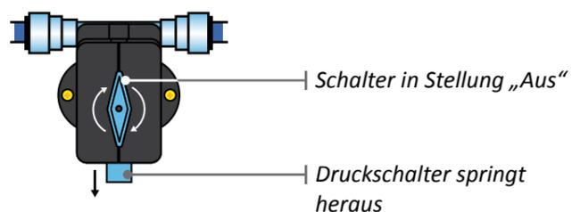
Das Wasser aus dem Boiler wird nun über das Ablassventil nach außen abgelassen. Stellen Sie einen Behälter unter den Auslass, um sicherzustellen, dass der Boiler vollständig geleert wurde (ca. 10 Liter).
