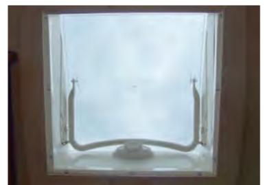
Um das Oberlicht zu öffnen, drücken Sie auf den Entriegelungsknopf, um den Bügel zu entriegeln, und ziehen Sie den Bügel nach unten. Ziehen Sie ihn dann zu sich hin, um ihn an einem der drei Öffnungspunkte einzurasten.
