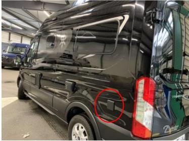
Zur Versorgung mit 230 V muss das Fahrzeug über eine genormte CEE-Kupplung links außen an der Rückseite des Fahrzeugs angeschlossen werden.
