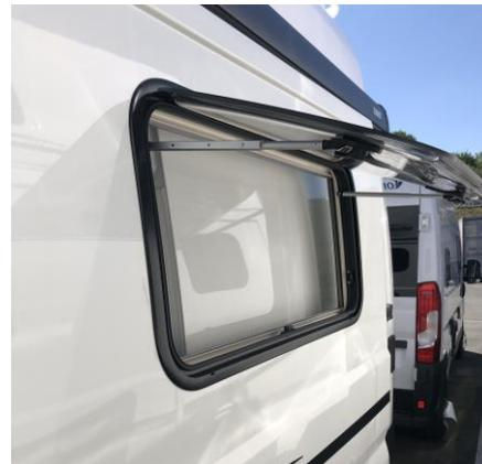
Zum Schließen des Fensters den Hebel bis zum Anschlag öffnen und dann herunterlassen.
