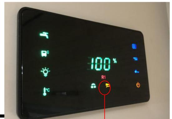
Wenn die Kontrollleuchte aufleuchtet und am Bedienfeld 100 % angezeigt werden, muss der Tank möglichst zeitig entleert werden.
