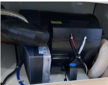
Ihr Fahrzeug ist mit einer Heizung mit integriertem Boiler des Typs TRUMA D6 ausgestattet, die sich im hinteren linken Kasten befindet.
