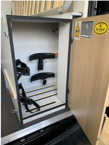
Vor jeder Stilllegung über einen längeren Zeitraum wird dringend empfohlen, die Gasflaschen abzutrennen und sie an einem gut belüfteten Ort zu lagern.
