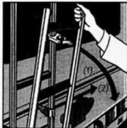
Wird die Dachleiter benötigt, ist diese einfach nach hinten abzuklappen (1). Ansonsten muß die Leiter immer zusammengeklappt und fest eingerastet sein. Mit beispielsweise einem Fahrradschloß können Sie die Dachleiter zusätzlich sichern. Die Dachleiter ist über die gesamte Heckbreite verschiebbar (2). Das gilt auch für Fahrradhalter und Skiträger.
