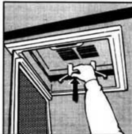
Vor dem Öffnen der Dachluke ist das Fliegengitter abzuklappen. Zum Hochdrücken (und Schließen) der Luke muß gleichzeitig die schwarze Griffsicherung eingedrückt werden. Die Lukenstellung ist vierseitig möglich. Während der Fahrt sollten die Dachluken geschlossen sein.
