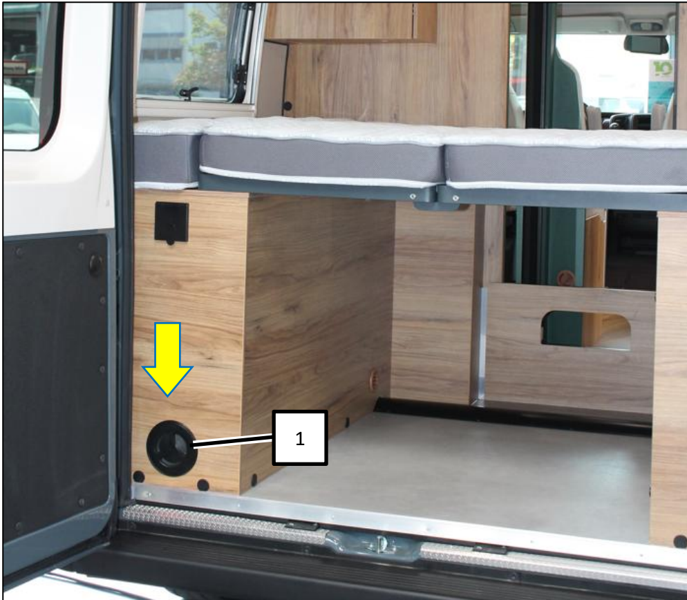
Zugang zum Ablass-Hebel des Frischwassertanks (Abb. beispielhaft)
