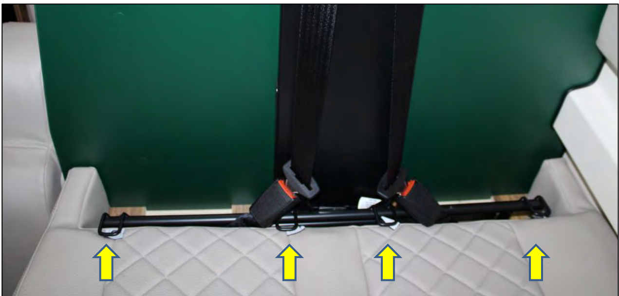
Isfix Bügel in der Sitzbank, Rückenpolster wurde entfernt (Abb. beispielhaft)
