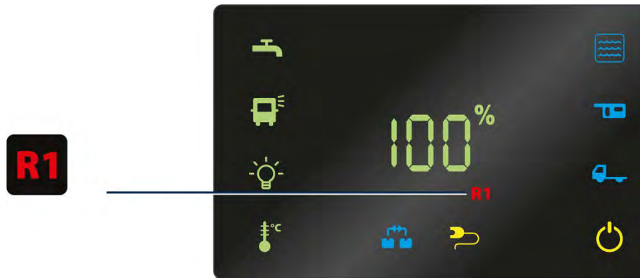
Warnsignal Abwassertank (Abb. beispielhaft)
