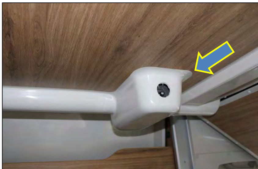
Zugang zum Antrieb des elektrischen Hubbetts (Abb. beispielhaft)
