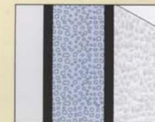
Eine aufwendige Isolierung (30 mm) zwischen den verstärkten Außen- und Innenwänden vermindert Heizungsverluste und ein schnelles Auskühlen des Innenraumes.
