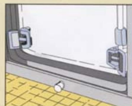
Zu öffnende Fenster können stufenlos geschwenkt werden. Ein einfaches Arretieren verhindert ein willkürliches Zuzschnappen.
