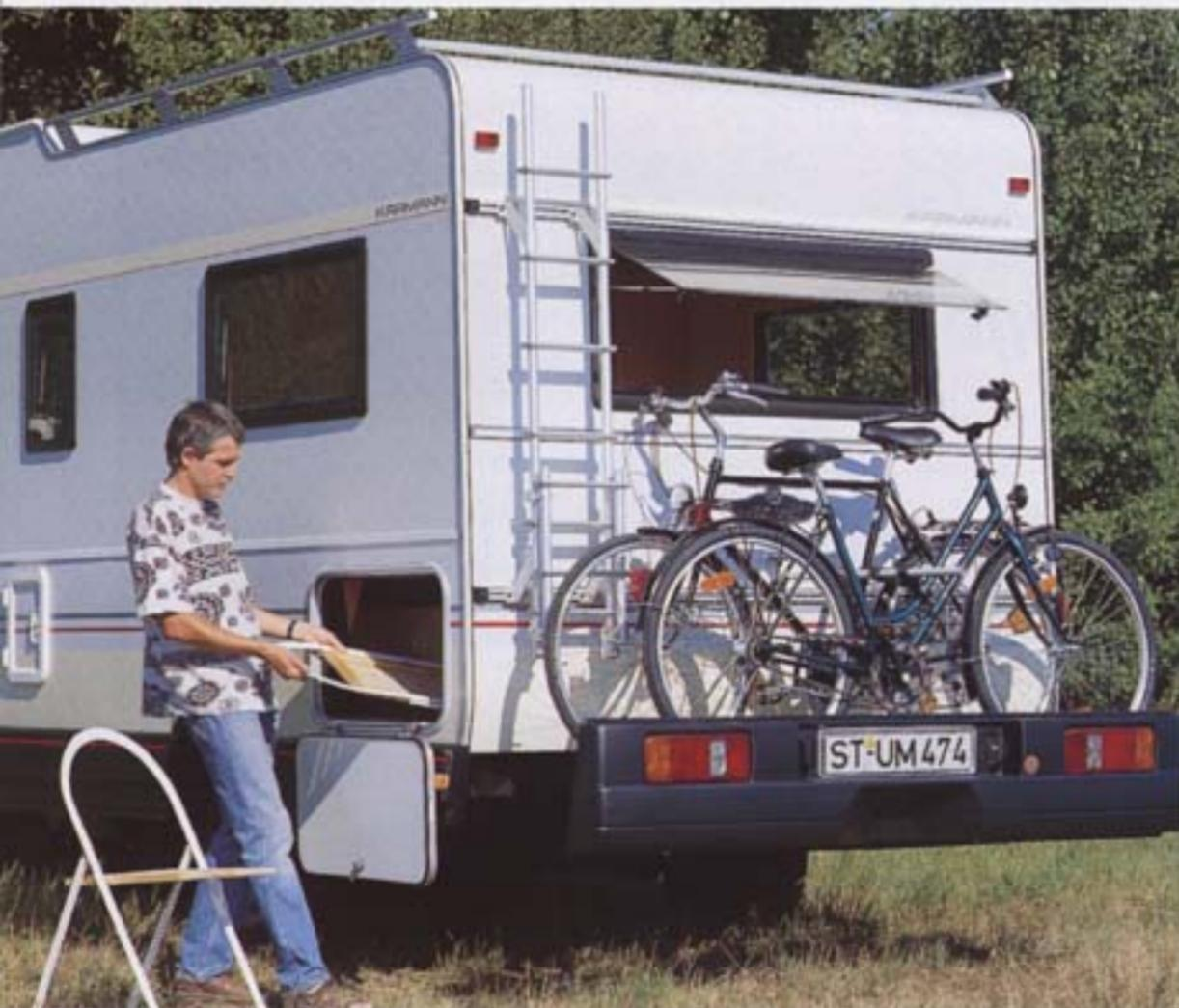
Die serienmäßige Dachreling erlaubt das Mitführen von Surfboards und ähnlichem. Der ebenfalls serienmäßige ausziehbare Stoßfänger eignet sich mit entsprechenden Haltern (als Sonderzubehör erhältlich) hervorragend zum Transport von Fahrrädern.
