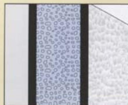
Eine aufwendige Isolierung (30 mm) zwischen den verstärkten Außen- und Innenwänden vermindert Heizungsverluste und ein schnelles Auskühlen des Innenraumes.
